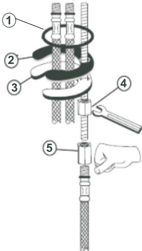
O-Ring (1) über die Schläuche und die Gewindestange schieben. Installieren Sie die Armatur wie dargestellt.
