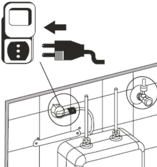
**9. Bitte die Anschlussschläuche handfest anziehen und mit einem passenden Maulschlüssel eine Umdrehung nachdrehen.**
