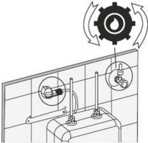
**Zur ersten Inbetriebnahme des offenen Speichers ist dieser mit Wasser zu füllen und zu entlüften.**
