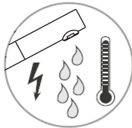
Lorsque l'eau est chauffée, de l'eau d'expansion s'échappe par l'évacuation, ce qui empêche l'éclatement du dispositif de chauffage d'eau en raison d'une surpression. Cette formation de gouttes ne peut et ne doit pas être arrêtée, et n'est donc pas une erreur technique. Cela ne constitue donc pas une raison pour une réclamation.
