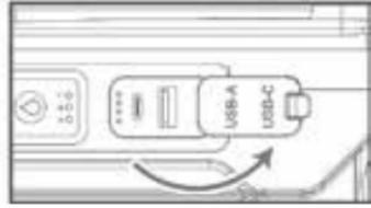
4. Podłączyć zasilacz kabla ładowania USB do pasującego źródła prądu.
