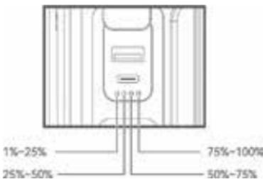
6. Le spie di controllo dell'apparecchio lampeggiano e indicano che l'apparecchio è in carica. Al 25% di ricarica una spia resta accesa, le altre continuano a lampeggiare. Al termine della ricarica (circa 4-5 ore), le spie di controllo si accendono con luce fissa.
