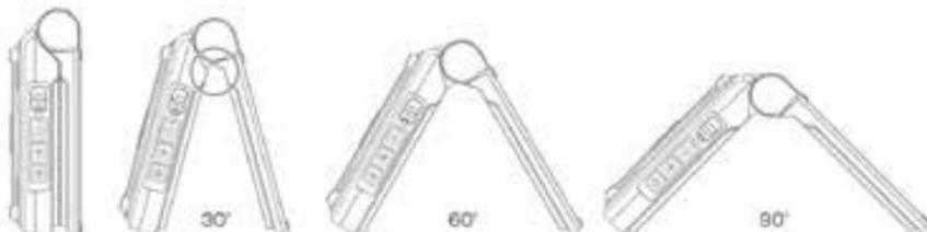
6. Klap het apparaat nooit verder dan de maximaal mogelijke openingshoek open, om schade aan het apparaat te voorkomen.
