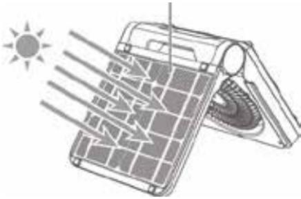
1. Die integrierte Solarzelle wandelt kontinuierlich Umgebungslicht in Energie um, die zur Aufladung des Gerätes genutzt wird. Dabei eignen sich jedoch Lichtquellen wie Leuchtstofflampen und andere Innenlampen nur sehr bedingt, so dass wir das Aufladen mit Sonnenlicht empfehlen.
