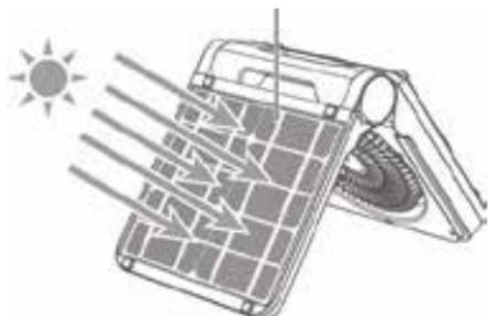
1. De geïntegreerde zonnecel zet continu omgevingslicht om in energie, die wordt gebruikt om het apparaat op te laden. Lichtbronnen zoals fluorescentielampen en andere lampen binnenshuis zijn echter slechts in zeer beperkte mate geschikt, dus we raden aan om op te laden met zonlicht.
