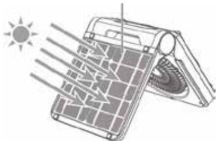
1. Zintegrowane ogniwo solarne ciągle przekształca światło otoczenia na energię, wykorzystywaną do ładowania urządzenia. Źródła światła takie jak świetlówki i inne lampy wewnętrzne są odpowiednie tylko w ograniczonym zakresie, więc zalecamy ładowanie światłem słonecznym.
