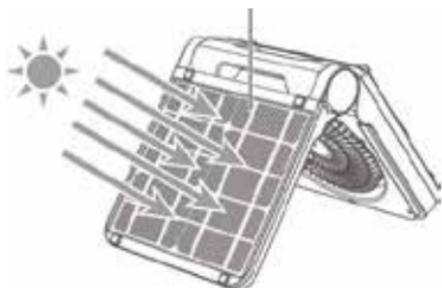
1. La célula solar integrada convierte continuamente la luz ambiental en energía que se utiliza para cargar el aparato. Sin embargo, las fuentes de luz como las lámparas fluorescentes y otras lámparas de interior son adecuadas solo hasta cierto punto, por lo que recomendamos cargar con luz solar.
