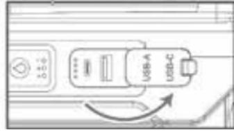
3. Verbinden Sie das andere Ende des Ladekabels mit einem USB-Ladegerät.
