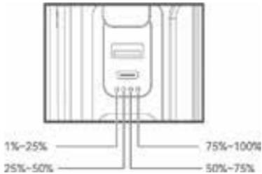
6. Los pilotos de control del aparato parpadean e indican que se está cargando el aparato. Con una carga del 25 %, un piloto permanece encendido, los demás siguen parpadeando. En cuanto haya finalizado el proceso de carga (tarda unas 4-5 horas), los pilotos de control permanecen encendidos permanentemente.
