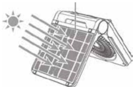
1. La cella solare integrata converte continuamente la luce ambientale in energia che viene utilizzata per la ricarica dell'apparecchio. Fonti luminose come lampade a incandescenza e altre lampade da interno sono adatte solo in misura molto limitata, per cui si consiglia la ricarica con la luce solare.
