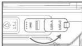
3. Branchez l'autre extrémité du câble de charge sur un chargeur USB.
