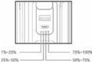
6. Les voyants de contrôle sur l'appareil clignotent et indiquent que l'appareil est chargé. À 25 % de la charge, un voyant reste allumé, les autres continuent de clignoter. Dès que le processus de charge est terminé (durée de 4 à 5 heures), les voyants de contrôle sont allumés en permanence.
