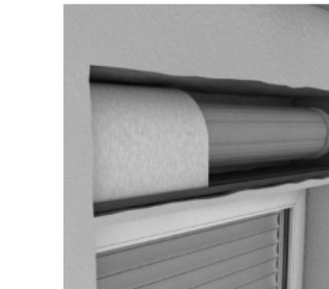
**4. Dämmung einbauen. Dämmung benötigt am Sturz und oberhalb des Blendrahmens einen Anschlag. (z. B. Winkel setzen)**
