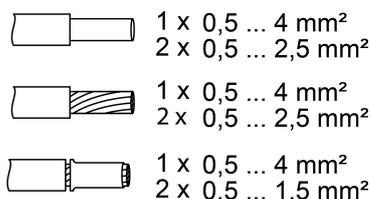
Bild 4: Klemmbare Leiterquerschnitte
