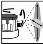
Variablen Sprühkopf auf Schadensgröße und Schadenslage einstellen.
