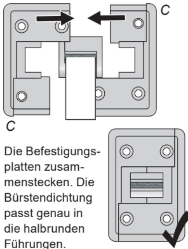
Die Befestigungsplatten zusammenstecken. Die Bürstendichtung passt genau in die halbrunden Führungen.
