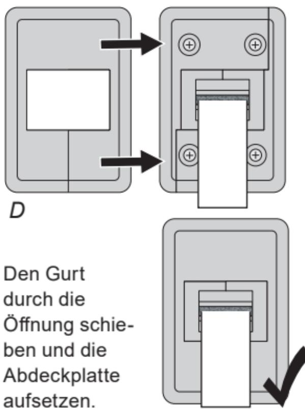
Den Gurt durch die Öffnung schieben und die Abdeckplatte aufsetzen.
