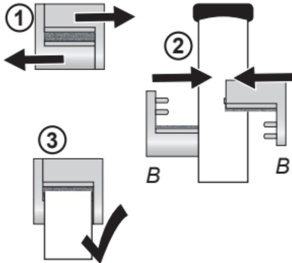
Die Bürstendichtung auseinanderziehen. Den Gurt zwischen den Bürsten nach vorne einfädeln und die Dichtung wieder zusammenstecken.
