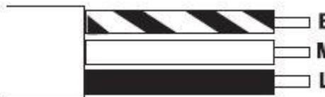
An den Enden der einzelnen Leiter sollte die Isolierung um ca. 12 mm entfernt werden. Alle blanken Erdungsleiter sollten bis auf 12 mm an das Ende heran ummantelt werden.
