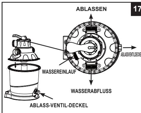
**WICHTIG:** Es befinden sich 3 Schlauchverbindungsöffnungen auf dem 6-Wege-Ventil, versichern Sie sich, dass die Abflussverbindung (vom Filter zum Pool) auf dem Ventil in Richtung Pool zeigt (siehe dazu Zeichnung 18).
