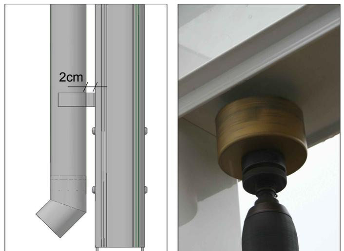
Mit einer Bohrkronen (Durchmesser 68-70mm) bohren Sie jetzt den Anschluß für das Fallrohr. Es kann sowohl neben als auch im Pfosten verbaut werden. **Bitte beachten Sie dabei den Versatz in der Rinnenpfette (siehe Detailzeichnung) sowie den Abstand der Clipphalter für das Fallrohr zum Pfosten ! (ca. 2cm)**
