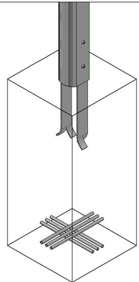
Platzieren Sie den Betonstahl in den Fundamenten, stellen Sie die verschraubte Rinnenkonstruktion in den Fundamentlöchern auf und richten sie darin mit Hilfe von Holzlatten und einer Wasserwaage aus.
