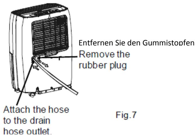
Befestigen Sie den Schlauch am Wasserablauf-Anschluss
