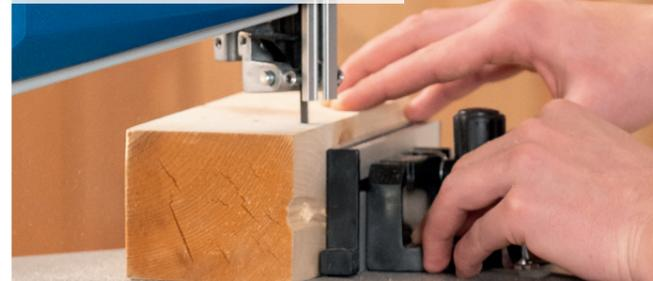
Selbst filigrane Sägearbeiten lassen sich dank der verschiedenen Sägebandbreiten mühelos umsetzen.
