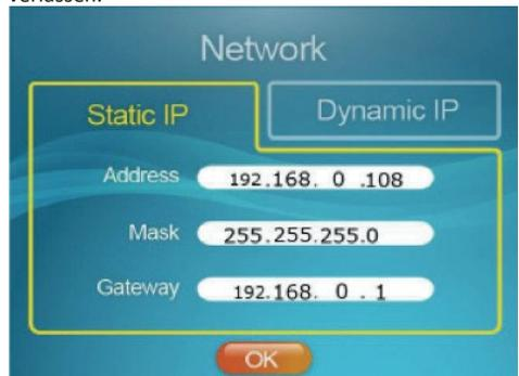
Standardmäßig wird empfohlen, die Einstellung Dynamic IP (Dynamische IP) beizubehalten, um die Netzwerkeinstellungen automatisch zu erhalten.
