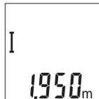
Drücken Sie zum Auslösen der Messung kurz auf die Messtaste **2**. Der aktuelle Messwert **c** wird in der unteren Zeile des Displays angezeigt. Der Laserstrahl wird ausgeschaltet.
