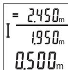
Drücken Sie zum Einschalten des Laserstrahls kurz auf die Messtaste **2**. Drücken Sie zum Auslösen einer weiteren Messung erneut kurz auf die Messtaste **2**. In der unteren Zeile wird der aktuelle Messwert **c** angezeigt. In der mittleren Zeile wird der vorhergehende Messwert **b** angezeigt. In der oberen Zeile wird die Auto-Summe **a** (Summe aus aktuellem und vorhergehendem Messwert) angezeigt.
