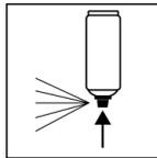
Wenn Sie die Lackierarbeit abgeschlossen haben, den Sprühkopf unter Wasser reinigen. Entfernen Sie zur Lagerung zunächst den Sprühkopf, legen Sie die Sprühsicherung wieder ein und setzen den Sprühkopf wieder auf.
